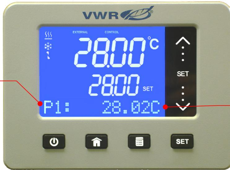
Température du bain mesurée par la sonde de surveillance
