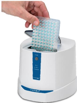
Remarque : Une légère vibration peut être ressentie, quand la centrifugeuse atteint la vitesse maximale. Une vibration excessive indique que le rotor n'est pas équilibré. NE PAS faire fonctionner la centrifugeuse non équilibrée. Utilisez toujours en tant que contrepoids une plaque de la marque, de type et de capacités des échantillons identiques.
