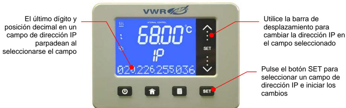
**Para cambiar:** Pulse **SET**. El último dígito y posición decimal en el primer campo de la dirección IP comenzará a parpadear. Utilice la barra de desplazamiento para introducir la dirección IP correcta para dicho campo y pulse **SET** para avanzar al siguiente campo de dirección. Repita hasta haber introducido los valores deseados para todos los campos de dirección IP.
