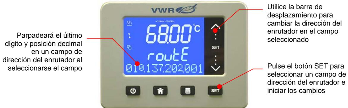
**Para cambiar:** Pulse **SET**. Comenzará a parpadear el último dígito y posición decimal del primer campo de la dirección del enrutador. Utilice la barra de desplazamiento para introducir la dirección del enrutador correcta para dicho campo y pulse **SET** para avanzar al campo de dirección siguiente. Repita hasta haber introducido los valores deseados para todos los campos de dirección del enrutador.
