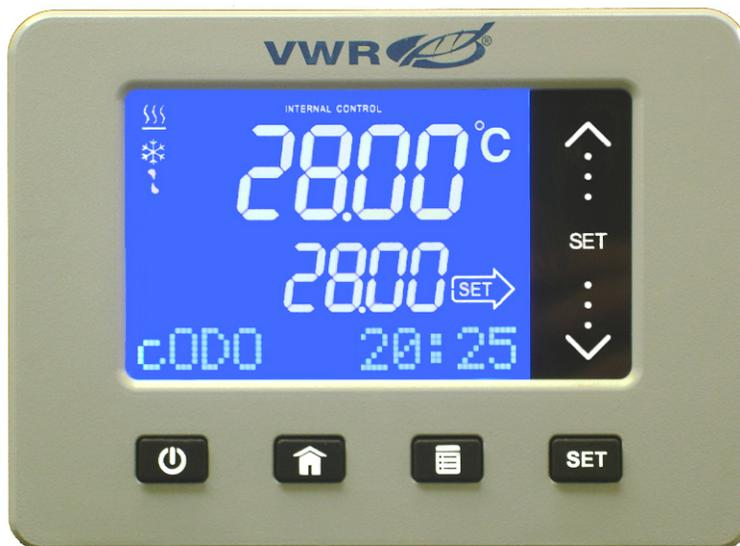
*Tiempo de funcionamiento del compresor – (se muestra aquí en horas y minutos)*
