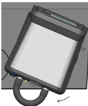
3. Levante el controlador directamente hacia arriba para sacarlo por la abertura de la plataforma superior del circulador.
