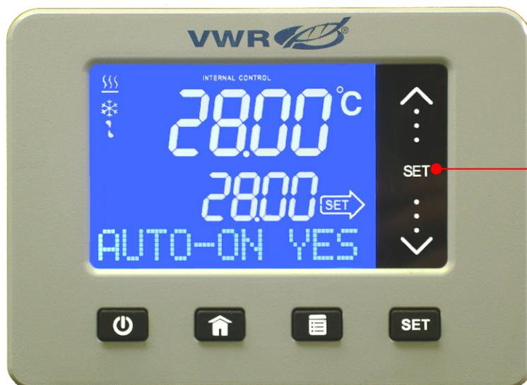
Toque la flecha superior para desactivar el encendido automático
