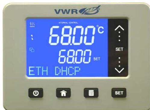
**Para cambiar:** Toque la flecha hacia abajo para seleccionar IP Fijo; toque la flecha hacia arriba para seleccionar IP DHCP.
