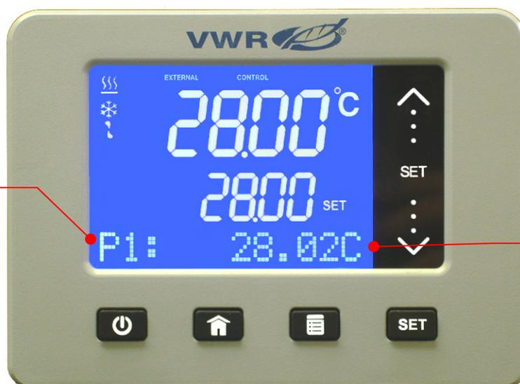
Temperatura del baño medida por la sonda de monitorización
