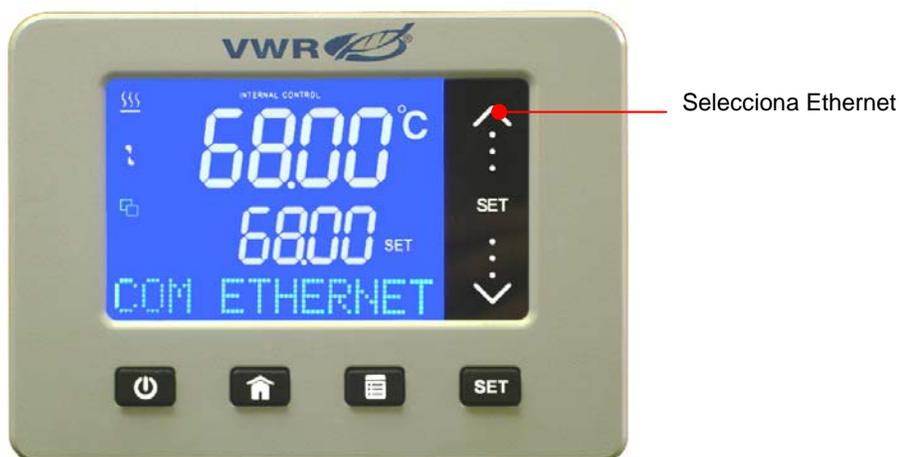
**Para acceder:** Pulse la tecla hasta que aparezca COM y el protocolo actualmente seleccionado en la pantalla.
