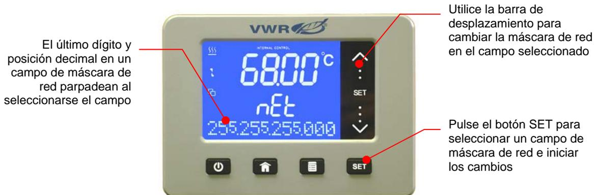
**Para cambiar:** Pulse **SET**. Comenzará a parpadear el último dígito y posición decimal del primer campo de la máscara de red. Utilice la barra de desplazamiento para introducir la máscara de red correcta para dicho campo y pulse **SET** para avanzar al campo siguiente. Repita hasta haber introducido los valores deseados para todos los campos de máscara de red.
